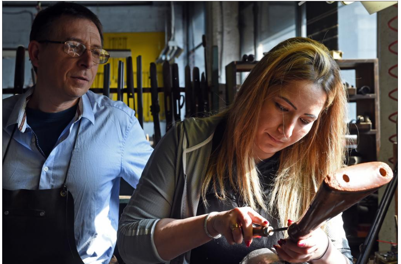
■ Hervé Bruchet observe Aravane Rezaï quadrillant la crosse d'un fusil afin de façonner un grip, qui empêchera la main de glisser sur l'arme. La sportive a passé quelques heures dans l'atelier Darne-Bruchet, racheté en 2013 par la société Fort Royal. Photo Yves FLAMMIN
